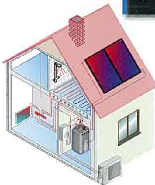
Tepelné čerpadlo + solární systém
